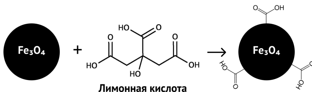
Рисунок 3. — Наночастицы магнетита, покрытые цитрат ионами
