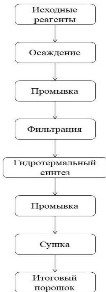
Рисунок 20 – Схема синтеза порошков на основе t\text{-ZrO}_2 гидротермальным методом [121, 151]
