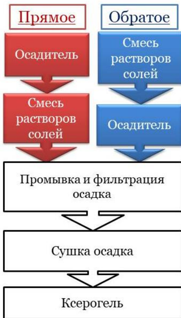
Рисунок 16 – Принципиальные схемы проведения процессов прямого и обратного осаждения
